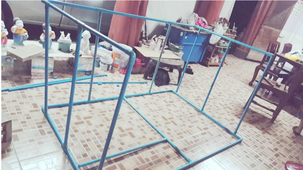
ภาพที่ 5.2 ภาพลักษณะของโครงที่จะนำมาใช้เป็นฐานสำหรับวัตถุจำลองเขาน้ำแข็ง
