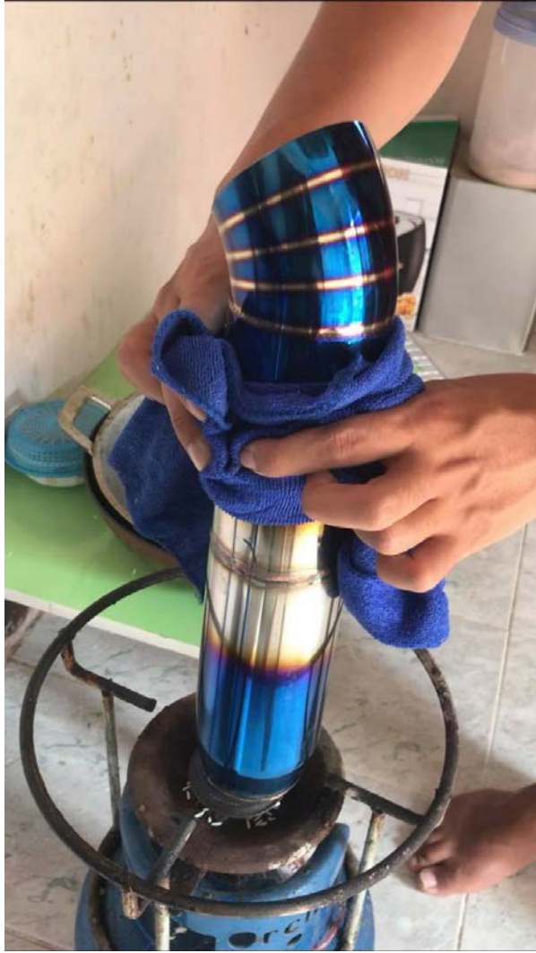
ภาพที่ 5.5 ทดลองเรื่องความร้อนกับเสียงกับท่อไทเทเนียม ที่มา: (มณีกาญจน์ กรองรัตน์, 2564)
